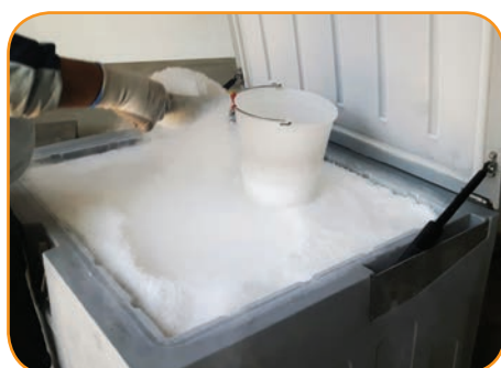
Il coperchio, che chiude ermeticamente anche senza agganciare la chiusura, rende più agevoli i ripetuti prelievi
