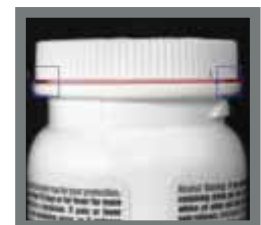
Verifica della presenza dei sigilli di sicurezza sulle bottiglie
